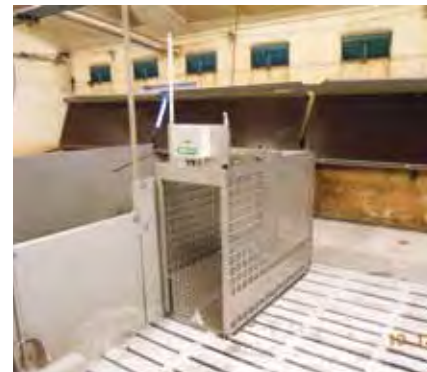
Fig.2: Gennemløbsvægt til automatisk vejning af grise.
