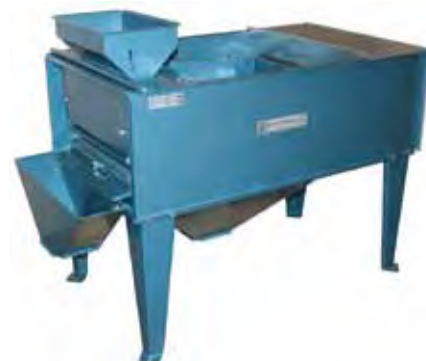
Der var ikke forskel på de tre testede kornrenseres renseevne. Denne soldrenser fra Øgendahl Maskinfabrik var den ene af de tre kornrensere, som blev testet.
